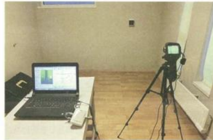
サーモカメラ等を使う「JJJ®断熱診断®」によるU値の実測
