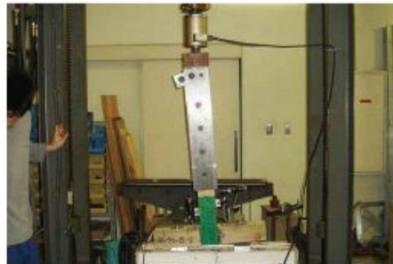
● 柱-土台の回転引張試験 (東京大学大学院 安藤研究室)
