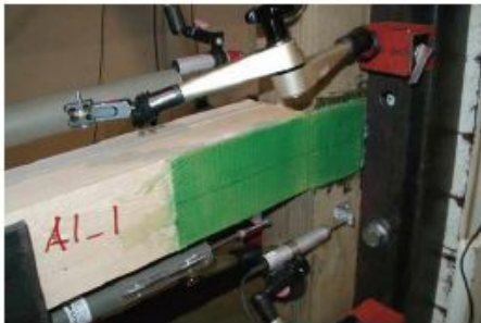
● 柱-土台の引張試験 (林産試験場)
