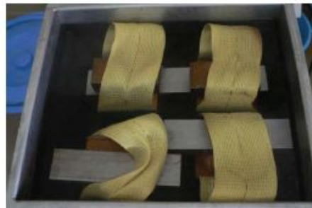
● 浸水・煮沸処理による促進劣化試験 (林産試験場)
