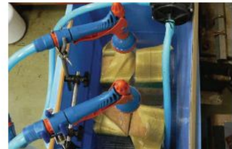
● 浸水・煮沸処理による促進劣化試験 (林産試験場)
