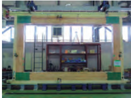
実大面内せん断試験（BOX型）
